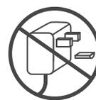
**6** 絕對禁止將電源線插頭上用於接地功能之圓金屬棒拔除，或是使用沒有接地功能的兩扁孔型插座，電源插頭應正確且牢固，禁止更改電源線或控制線路以確保使用者人身安全。
